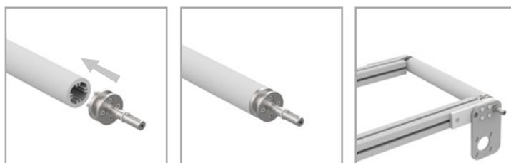
**Terminale con gole motorizzazione rinviata VF30P con rulli Ø50**
