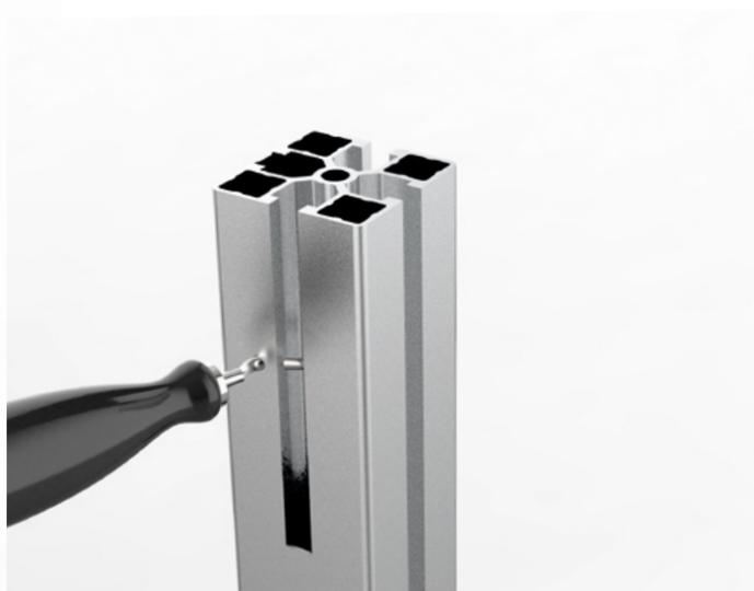
I profili “pelabili” permettono inoltre di praticare velocemente asole, forando secondo l'interasse richiesto e asportando la parte rimanente.
