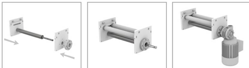
Schema lavorazione rullo motore centrale Ø35
