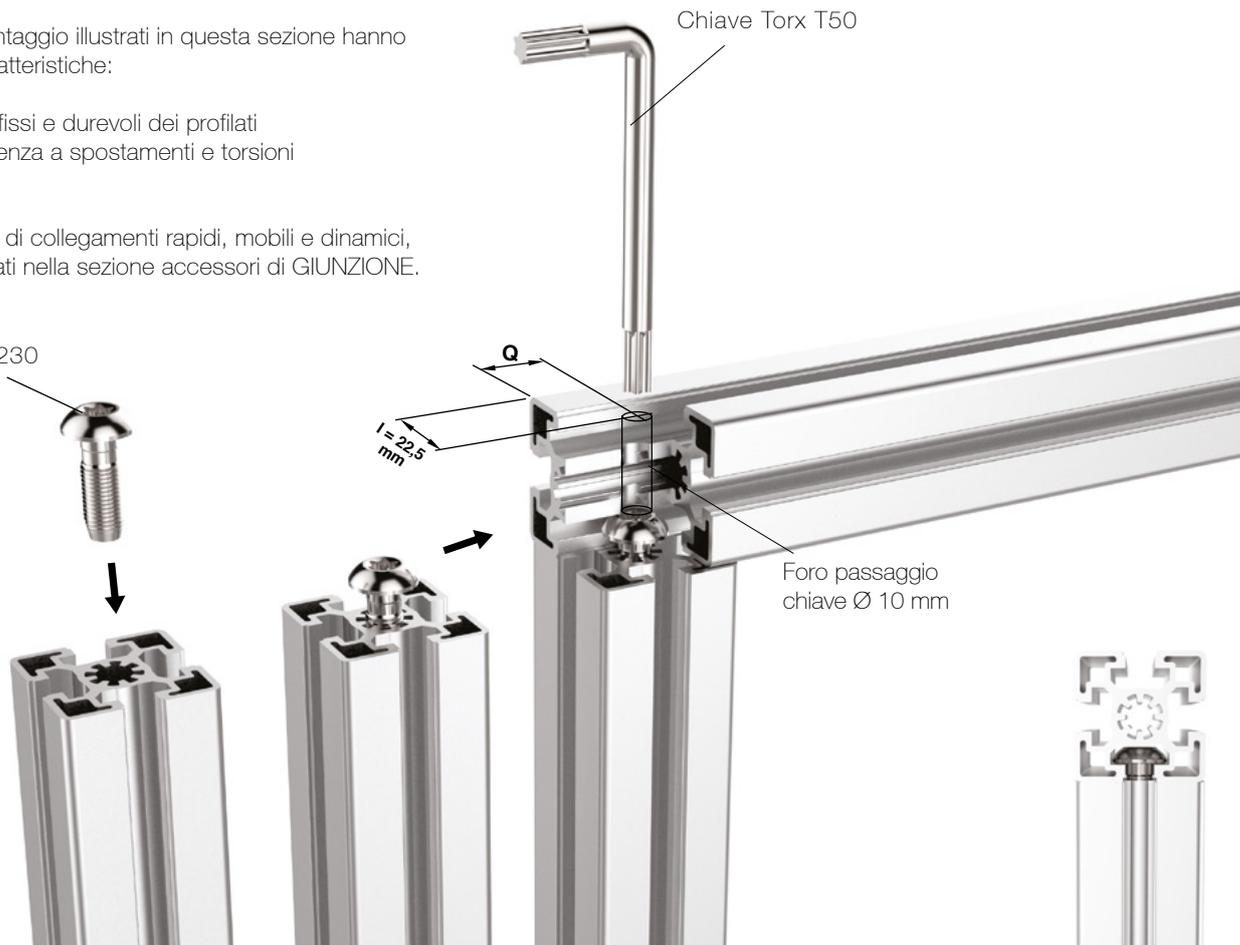
Per la serie **45 cava 10**, una prima modalità di giunzione tra profili si realizza utilizzando una vite autofilettante, da applicare nel foro centrale della sezione. La vite in fase di assemblaggio, va avvitata parzialmente, in modo da permetterne lo scorrimento in cava fino alla posizione definita.
