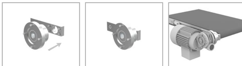
**Distanziale motorizzazione diretta VF30P con rulli Ø35**
