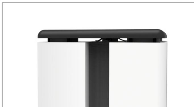
Il piantaggio si perfeziona per interferenza del corpo a croce del tappo con il foro centrale del profilo.
