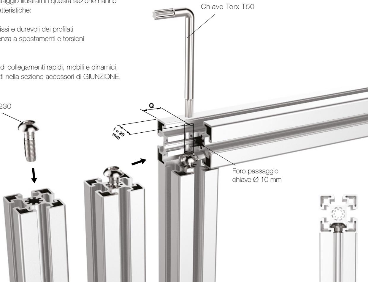
**Per la serie 40 cava 10**, una prima modalità di giunzione tra profili si realizza utilizzando una vite autofilettante, da applicare nel foro centrale della sezione. La vite in fase di assemblaggio, va avvitata parzialmente, in modo da permetterne lo scorrimento in cava fino alla posizione definita
