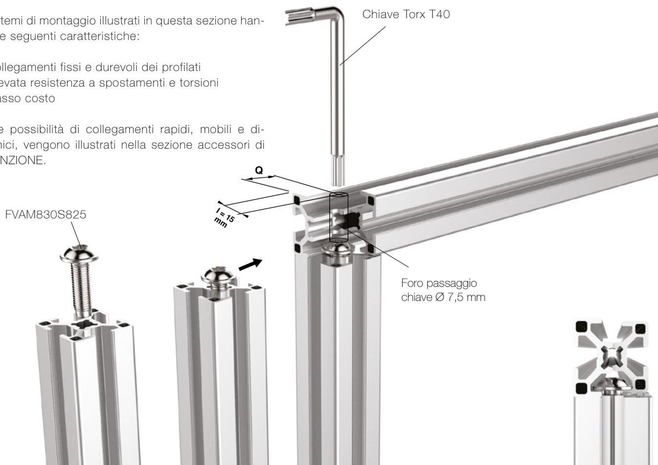
**Il collegamento di testa dei profili** può essere realizzato utilizzando una vite autofilettante, da avvitare nel foro centrale della sezione. La vite in fase di assemblaggio, va avvitata parzialmente, in modo da permetterne lo scorrimento in cava fino alla posizione definita.
